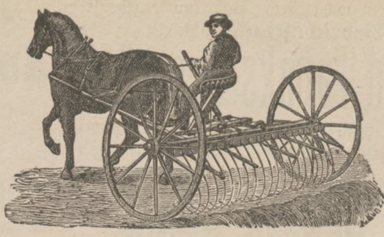
Patent-Pferderechen mit selbstthätiger Entleerung und 28 Zinken.
