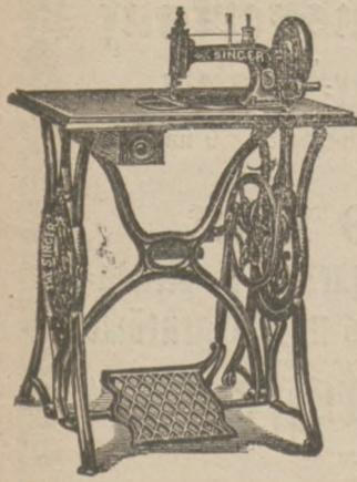
finden an Güte und Leistungsfähigkeit unübertroffen. Sie sind mit den neuesten Vervollkommenungen und Apparaten, sowie mit einem neuersfundenen Tretgestell versehen, an welchem Treibrad und Tritt auf Stahlspitzen laufen, wodurch den Maschinen ein fast geräuschloser und der denkbar leichteste Gang verliehen wird.
