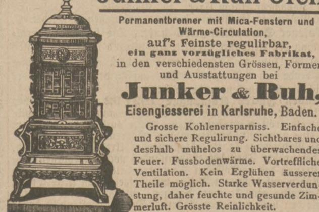
Permanentbrenner mit Mica-Fenstern und Wärme-Circulation,
