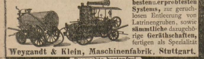
besten erprobtesten Systems, zur geruchlosen Entleerung von Latrinengruben, sowie sämtliche dazugehörige Gerätschaften, fertigen als Spezialität
