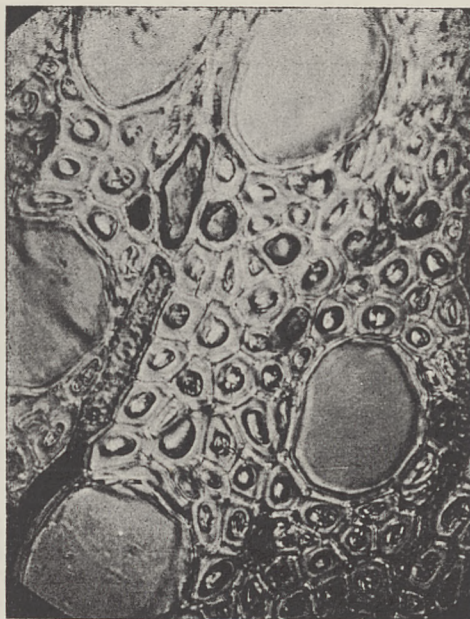
Ryc. 10. Przekrój poprzeczny drewna bukowego ze strefy zabarwionej nieregularnie. Większość elementów składowych drewna wypełniona jest silnie załamującymi światło substancjami. Pow. ok. 400 r. Mikrofotoł, autora.
