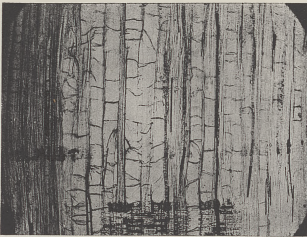
Ryc. 11. Przekrój podłużny promienisty drewna buka w strefie granicznej. Wcistki przegródkowe w naczyniach. Pow. około 65 r. Mikrofot. autora.
