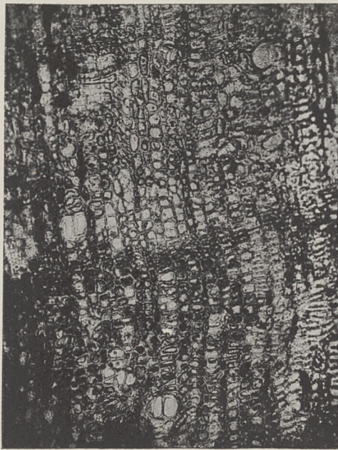
Ryc. 13. Przekrój poprzeczny drewna anormalnego-miękiszowego. Tu i ow- dzie widać rozrzucone naczynia. Pow. ok. 65 r. Mikrof. autora.
