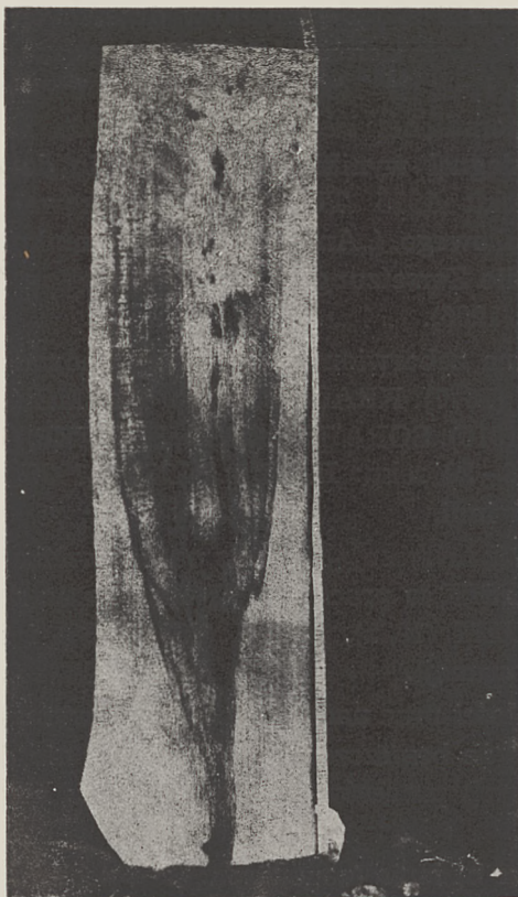
Ryc. 2. Charakterystyczny obraz zmian barwnych w drewnie na przekroju podłużnym pnia przemrożonego buka.
