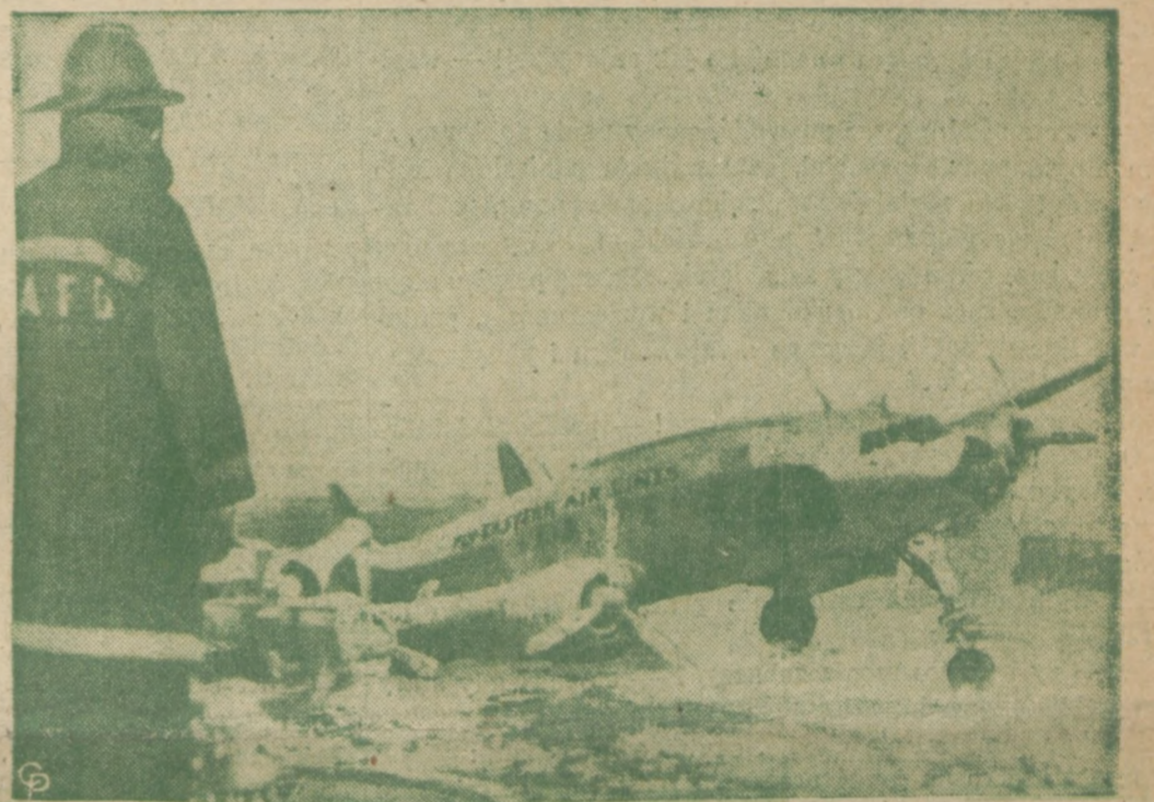
SZCZESLIWIE—BEZ OFIAR. — Samolot transportowy Eastern Airlines Constellation, lądując na lotnisku w Waszyngtonie złamał podziurkując prawe koło i siksrajac się na swym hoku na przestrzeni około 600 stóp urządzenie podziurkujące zatrzymało się, dzięki czemu tak załoga jak i 60 pasażerów zostało uratowanych bez żadnych nawet obrażeń.
