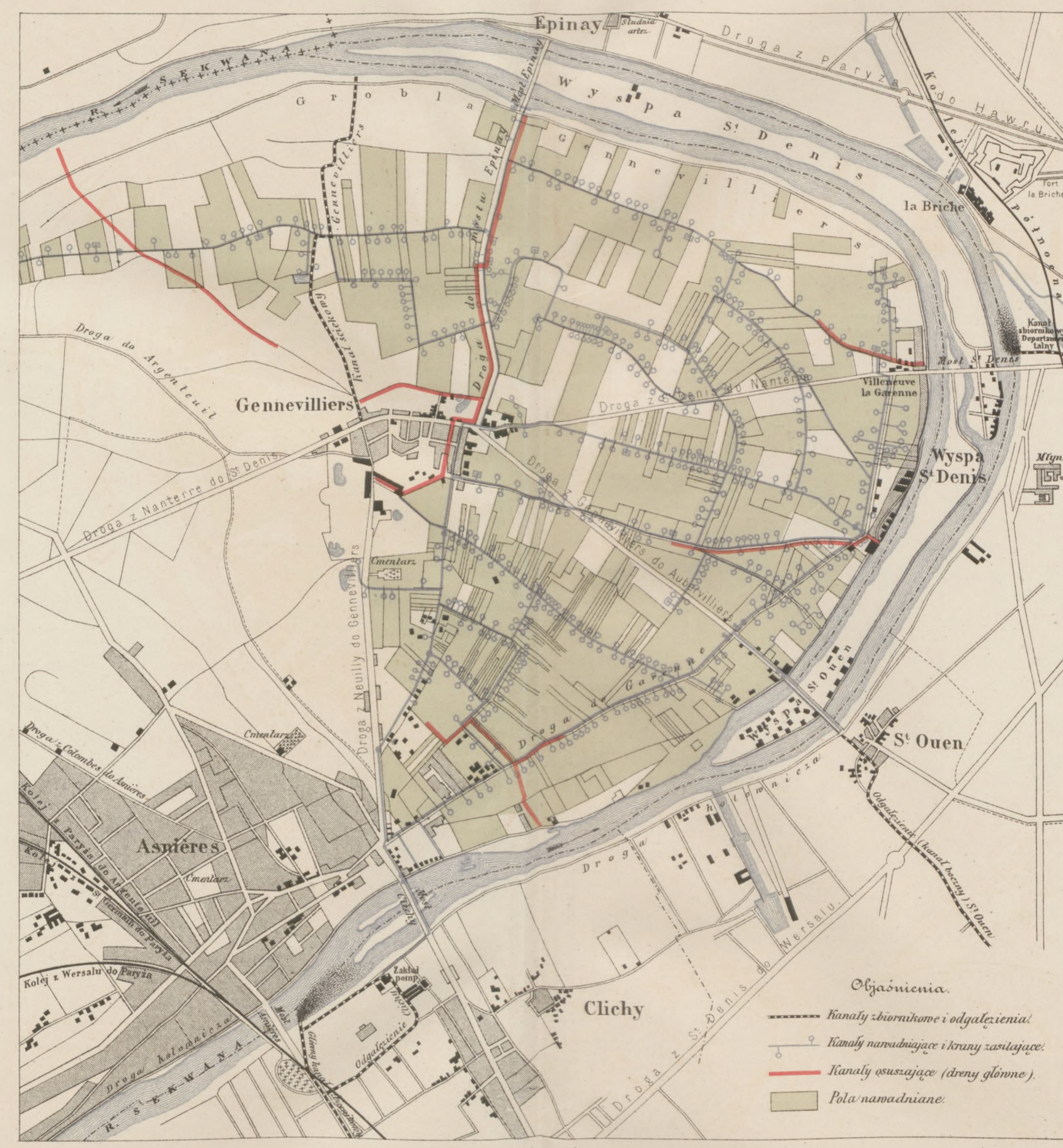
Rys. 2. Sieć kanałów na polach Gennevilliers.
