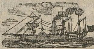
Das gekupierte Dampfschiff Stralsund mit trennbaren Maschinen von 55 Pferdekraft, neuem Röhren-Kessel und neuer Kasüten-Einrichtung, wird in diesem Sommer regelmäßige Passagierfahrten zwischen Stralsund, Putbus, Swinemünde und Stettin machen.
