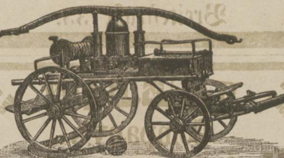
Das Wagengestell ist sehr solide konstruit und geben die entsprechend hohen Räder demselben die notwendige leichte Transportfähigkeit. Die durchzubilden eisernen Achsen halten Normal-Spurmaß und der Vorberwagen ist vollständig durchdacht!
