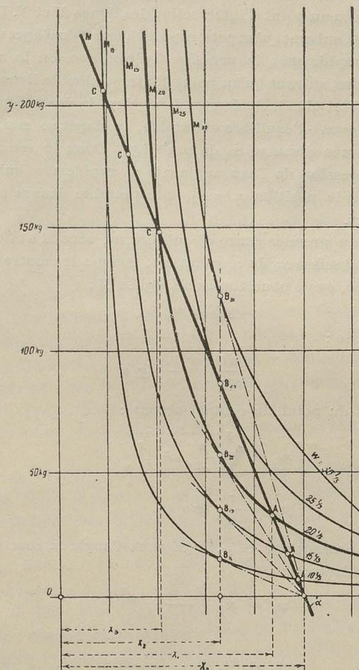
Le ressort de la soupape réagit contre la pression de l'eau. Sa résistance  $z$  est proportionnelle à la déformation et se présente, pour cette raison, dans le diagramme, sous forme d'une droite inclinée  $N$ . Lors de la position primitive du clapet ( $x = x_0$ ), le ressort n'exerce aucune pression. A mesure qu'il est comprimé jusqu'à une certaine valeur  $x$  de plus en plus petite, sa résistance  $z$  augmente et la relation constante qui existe entre la résistance et la déformation :
