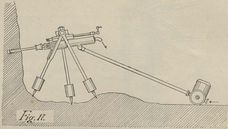
Les avantages qui établissent la supériorité du bélier perforateur sur les autres machines (sans compter les avantages généraux de la transmission hydraulique), consistent en un rendement de beaucoup supérieur à celui qu'il est possible d'atteindre avec les moteurs pneumatiques.
