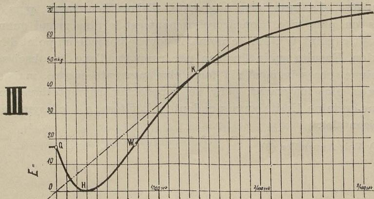
Dans le cas qui nous occupe, l'obturateur n'est pas fixe, ni ne cède avec une vitesse constante, car la vitesse du piston est variable. La colonne d'eau frappe la masse inerte du trépan, au moment où il remontait sous l'impulsion du ressort  $F$  (fig. 1). Pendant la durée de la percussion, la vitesse du piston  $v$  varie constamment; de négative qu'elle était au commencement, elle s'annule puis, devient positive et augmente de plus en plus.
