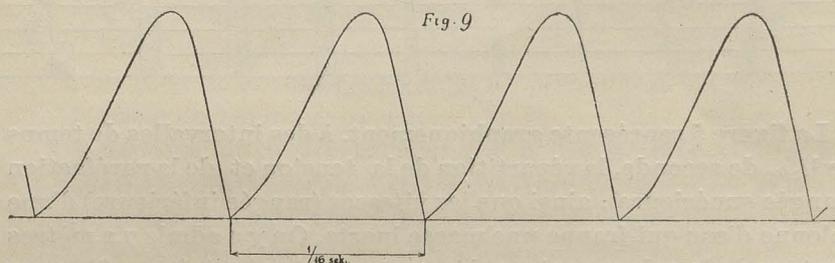
La figure 9 est un fac-simile (grandeur naturelle) d'un diagramme obtenu directement sur l'appareil. La forte inclinaison initiale de la courbe, immédiatement après le choc, s'explique par le fait du rebondissement du trépan qui, lors de l'expérience, portait contre un corps en acier trempé. Dans la roche même la plus dure, ce rebondissement est à peine perceptible.
