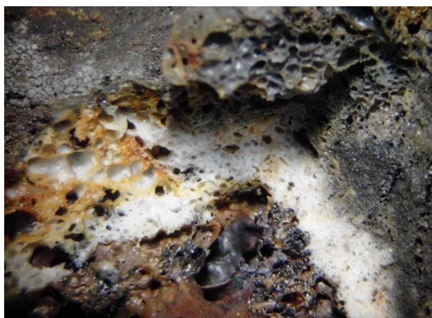
Fig. 3. Przykładowe makro i mikrografie żużli: Precypitaty (siarczany i węglany) na powierzchni żużla (na górze), Zeskliwiony fragment żużla (na dole).
