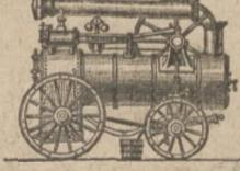
Mit einem 60" breiten Dampfdreschapparat durch das Dominium Alt-Röntgen in 10 Arbeitsstunden 28,000 Pfd. Roggen mit nur 110 Ko. Kohlenverbrauch. [2354]
