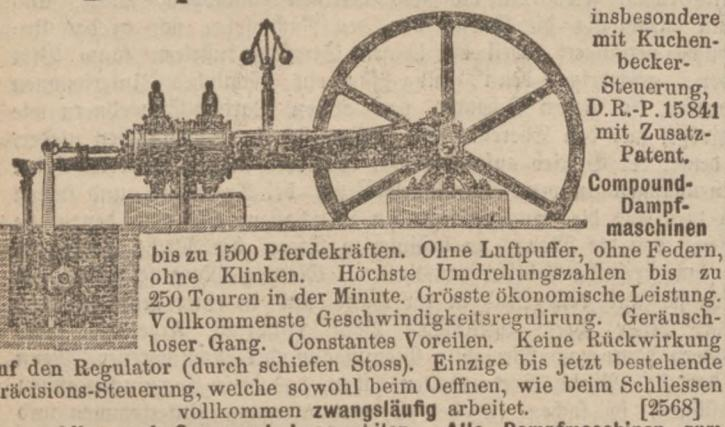
insbesondere mit Kuchenbecker-Steuerung, D.R.-P. 15841 mit Zusatz-Patent. Compound-Dampfmaschinen
