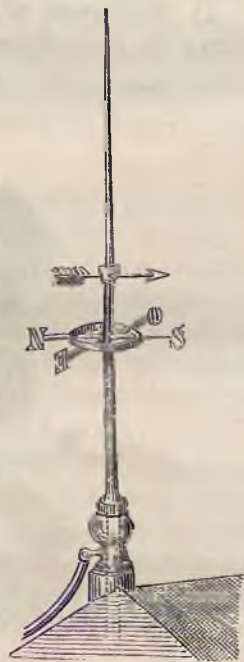
Fig. 146. Górny koniec konduktora piorunowego,
