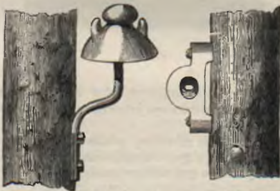
Fig. 158. Inne kształty dzwoneków porcelanowych odosobniających.
