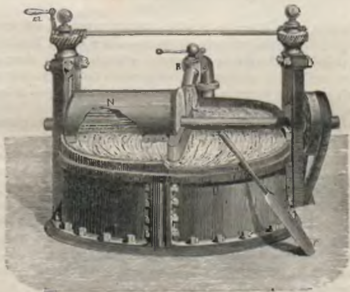
Fig 13. Maszyna do rozdrabniania gałganów.
