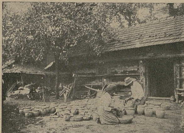
Polewanie glejtą naczyń glinianych w Buczkowie, pow. bocheński
