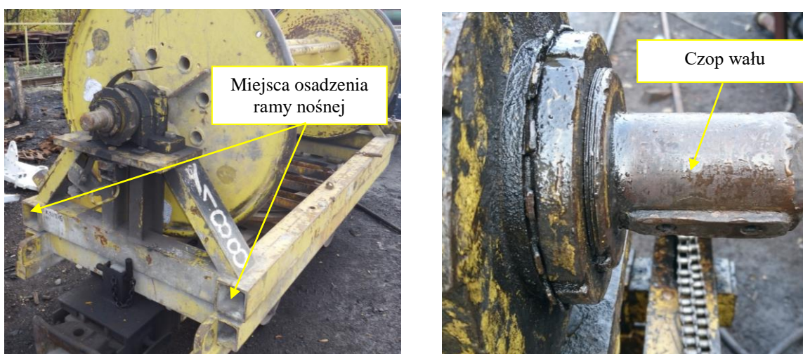
Rys. 4. Linowóz typu WKL.001 – widok ogólny oraz czop wału [1]
