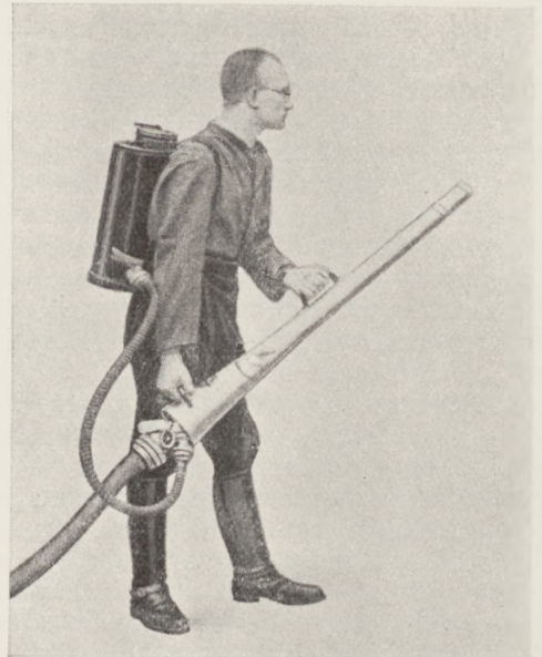
Rys. 7. Prądownica pianowa ze zbiornikiem plecakowym.
