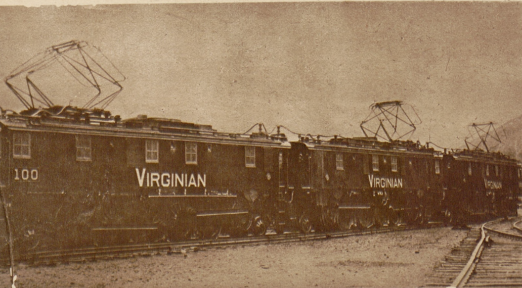
Linja kolejowa w Wirginji (St. Zj.) jest obecnie zupełnie zelektryfikowaną i posiada największe lokomotywy pociągowe i ciężarowe.
