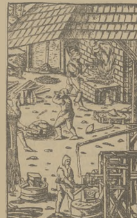
BUDNICA, „Rudnica” A — Ognisko, B — stos, C — wycięte szaki, D — masa żelazna, E — młotki drewniane, F — młot, G — kuznia. (Istnieć z wydawnictwa „Wiedza” pracej przy ognisku, na którym ruda żelazna jest pomieszana z węglem. Nielej dwa hutnicy odbijają młotami kawałki szaki od bryły przetopionej żelaza.
