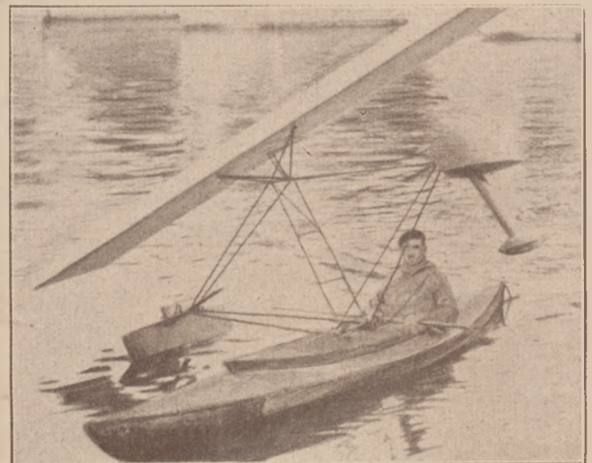
Nowy typ żagla w kształcie ruchomego skrzydła samolotu.
