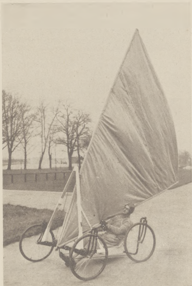
Inżynier niemiecki zbudował wóz żaglowy, na którym przy pomyślnym wietrze osiąga, na równej drodze, 60—100 km. na godzinę.
