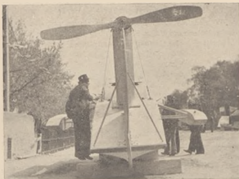
Nowy ślizowiec skonstruowany przez Francuza Inz. Rene Morin osiągnął szybkość 60 mil. ang./godz.
