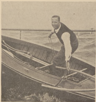
Wicemistrz olimpijski Krogmann. Widac ciekawe szczegóły łodzi: zamiast poprzeczki lina, zaczepy liny mieczowej przy falochronie.
