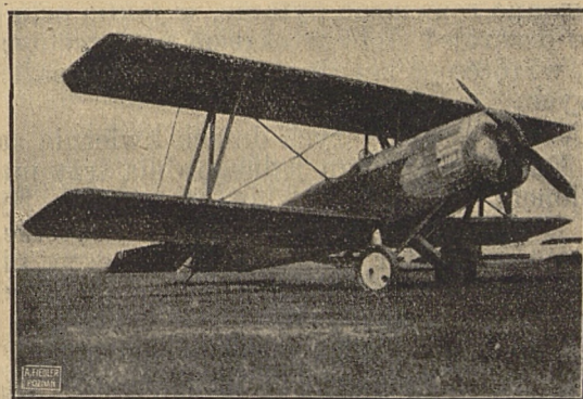
Taki samolot wpada też w korkociąg, odznacza się jednak tem, że łatwo wychodzi. Płatowiec ten buduje fabryka „Samolot“. Skonstruował go inż.-pilot Ryszard Bartel.
