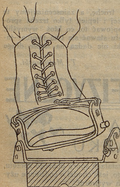
Rys. 2. Wkładanie trzewika, zaopatrzonego w podkładkę ze szczękami do szczęk zewnętrznych nakładki.
