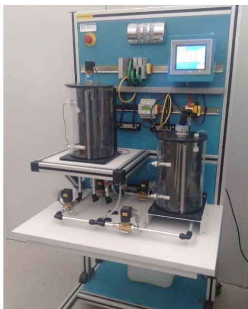
Rys. 6. Stanowisko dydaktyczne do e-learningu programowania sterowników PLC w zakresie regulacji poziomu cieczy
