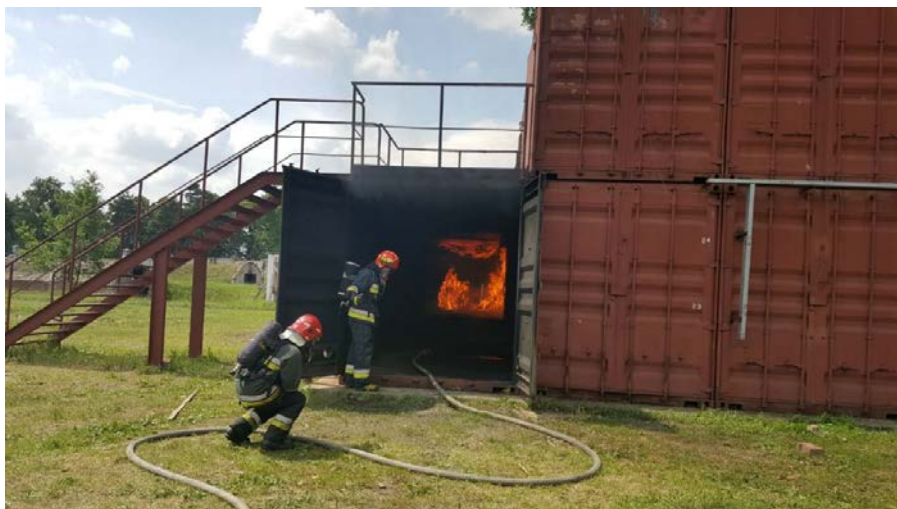
Rys. 5. Przykład trenażera fizycznego, komora rozgorzeniowa znajdująca się na terenie Centralnej Szkoły PSP w Częstochowie
