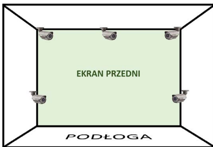
Rys. 3. Schemat instalacji kamer podsystemu motion capture zintegrowanego z trenerem typu CAVE
