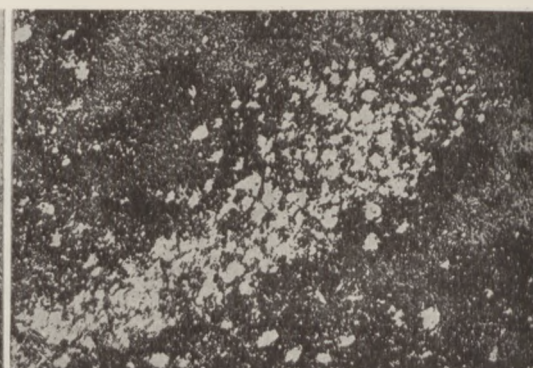
Rys. 15. Przekrój przez „cień“ z rys. 14, widoczne po trawieniu skupienie węglików.
