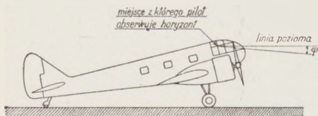
Rys. 5. Widoczność w kabine pilota w samolocie wielosilnikowym
