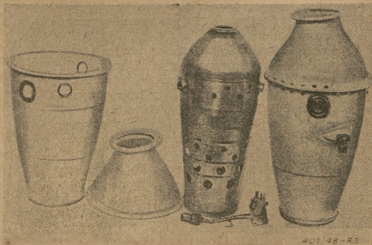
Rys. 5. Komora spalania silnika Nene I (Rolls Royce) wraz z jej częściami składowymi.
