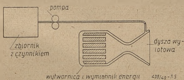
Rys. 5. Schemat silnika rakietowego napędzanego energią atomową.
