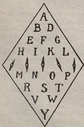
Schemat, wyjaśniający działanie pierwszego aparatu telegraficznego Wheatstone'a. W naszym wypadku aparat nastawiony jest na literę B.
