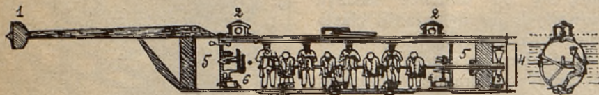
„Dawid” — Onley'a. 1) Mina, 2) Łuki wejściowe, 3) Śruba napędowa, 4) Ster pionowy, 5) Cysterny balastowe, 6) Pompy do cystern balastowych.
