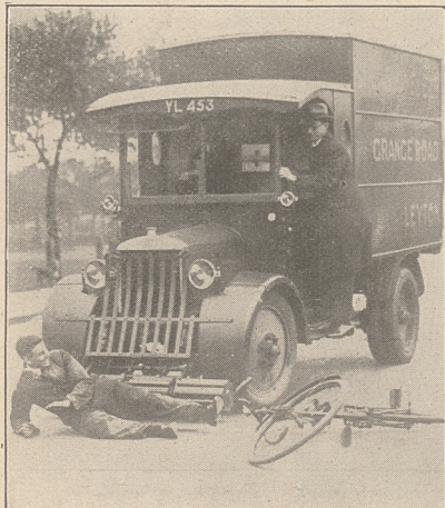
Przyrząd, hamujący automatycznie samochód z chwilą pierwszego zetknięcia z napotkaną przeszkodą, ma zapobiegać nieszczęśliwym wypadkom i zaczyna być stosowany w Londynie.
