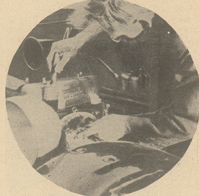
W końcu obmywamy motor naftą, usuwając troskliwie pył metalowy.
