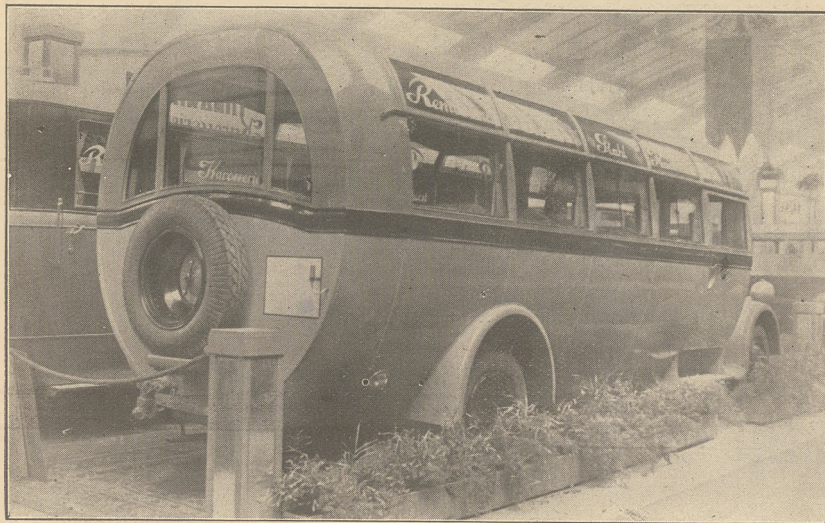
Karoseria autobusowa „Tubus”, firmy Nembrandt, cała ze stali i aluminium. Fot.: Wide-World
