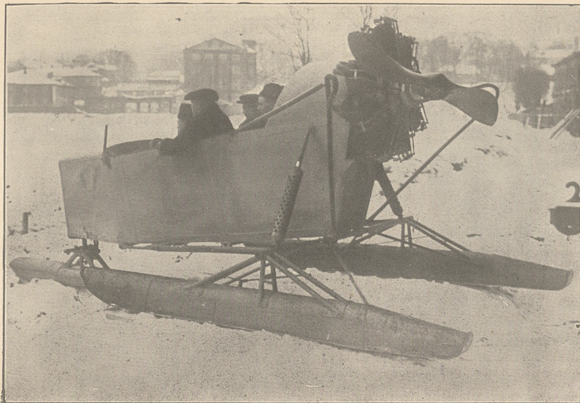
Aero-sanie rosyjskie z silnym lotniczym motorem.
