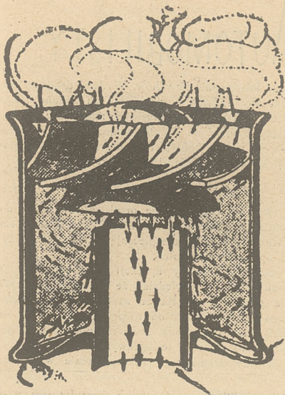
Rys. 8. Inna odmiana filtra do powietrza działającego na zasadzie siły ciężkości i siły centrifugalnej.
