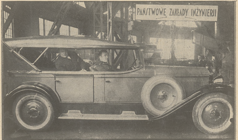
Samochód C. W. S. Państwowej Wytwórni Samochodów 42 K. M. z karoserją otwartą.
