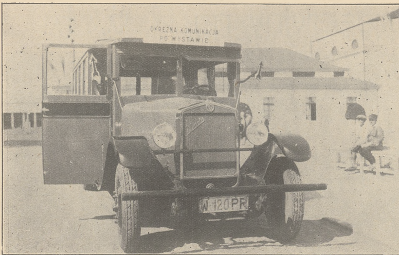
Autobus „Ursus” na podwoziu typu „AW”, karosowany przez firmę Plage i Łaskiewicz. Widok z przodu. Fot. „Samochód”
