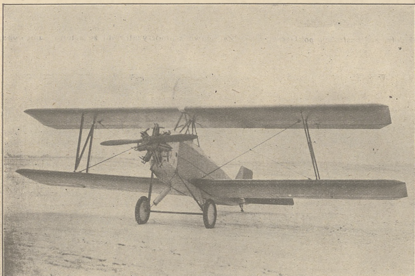
Samolot inż. K. Bartła, „BM-3”, z silnikiem Walter 85 KM., wykonany w fabryce „Samolot” w Ławicy.
