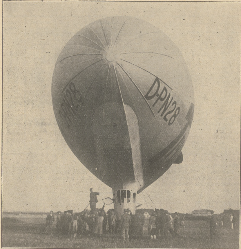
W Stolp (Słupsk) na Pomorzu niemieckim dokonano prób z nowym, małym balonem sterowym typu Parseval-Naatz, które wypadły bardzo dodatnio. Balon przebywał w powietrzu godzinę i do skonałe reagował na stery. W przeciwieństwie do Zeppelina, który posiada ciężkie, sztywne i kosztowne rusztowanie aluminiowe, Parseval jest typem balonu „półsztywnego”. Kwestia wyższości jednego czy drugiego systemu była zresztą już przed wielu laty tematem ciągłych dyskusyj obu konstruktorów, hr. Zeppelina i mjr. Parsevala. Fot. Scherl
