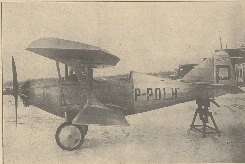
Awionetka „Skraba ST3”, konstrukcji pilota B. Skrabę. Silnik Salmson 40 KM.
