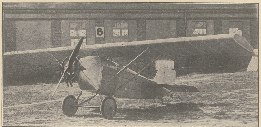
Awionetka jednomiejscowa „Orkan II” konstrukcji por. pil. Tadeusza Grzmilasa. Silnik Anzani 45 KM.
