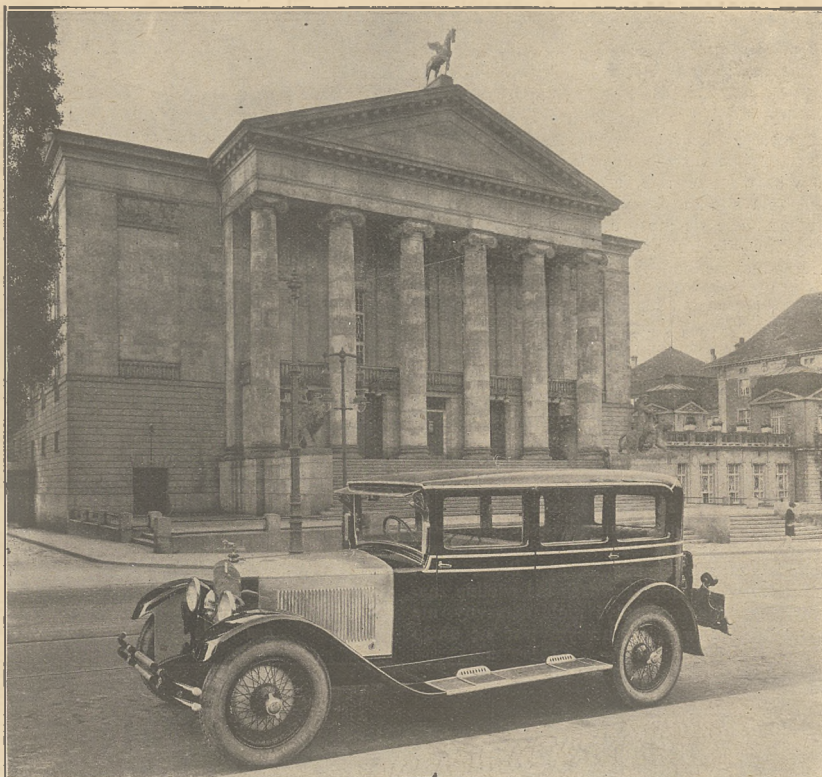
6-cylindrowa luksusowa limuzyna na podwoziu „Itala” z wewnętrzną stacją odbiorczą radjową, karosowana w firmie „Hempowiczautomobile” w Poznaniu.
