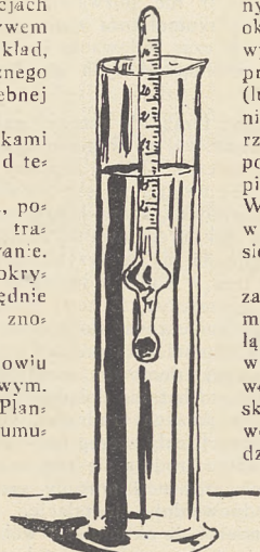
Stężenie kwasu należy mierzyć przy pomocy areometru, który pozwala na szybkie określenie ciężarów właściwych cieczy.
