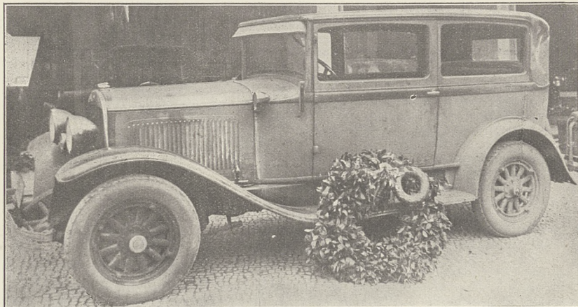
Samochód seryjny marki Chrysler 13/35 KM. przejechał na torze Avus w jeździe non-stop w 69 dniach 2 godzinach i 3 minutach 86 439 klm. Zużył on ogółem 11 577 ltr benzyny, czyli 13,39 ltr na 100 klm.
