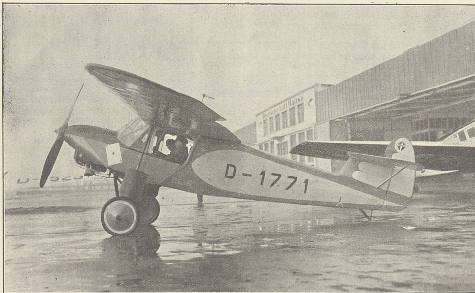
Najnowszy typ awjonetki turystycznej „Arado” z czterocylindrowym silnikiem, chłodzonym powietrzem, z cylindrami wiszącymi. Dwa miejsca obok siebie w oszklonej kabine
