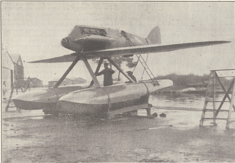
Wodnopłatowiec Nieuport-Delage z silnikiem Hispano-Suiza o mocy 1 400 KM., chłodzony wodą rozwinął podczas pierwszego lotu szybkość około 510 klm na godzinę.
