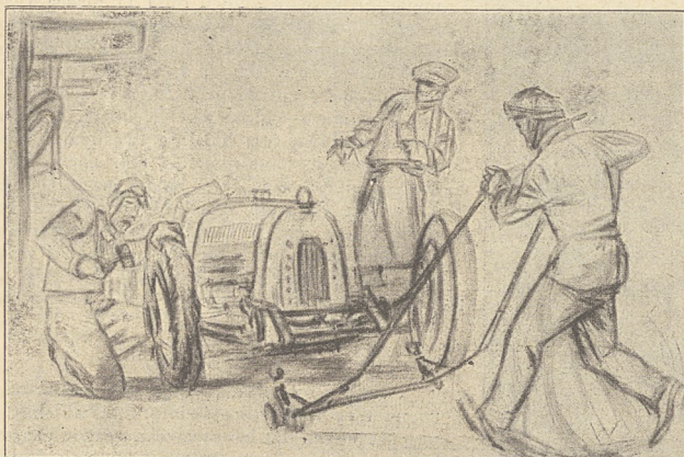
Wyścigi obfitują w defekty gum. Podczas gdy mechanik lewaram podnosi przód wozu, kierowca zdejmuje zniszczone gumy. Wszystko odbywa się niezwykle szybko i pod nadzorem komisarza.
