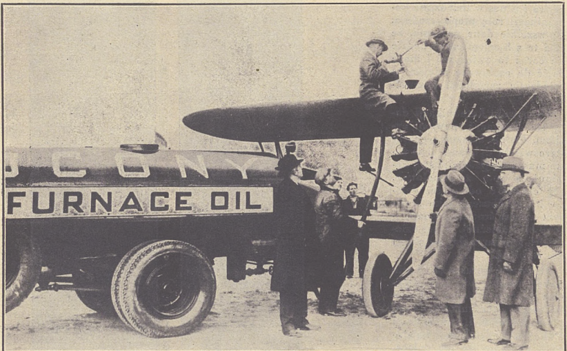
Na lotnisku w Hartford w Stanach Zjednoczonych odbyły się próby z silnikiem lotniczym na paliwo ciężkie, które dały zadowalające wyniki.
