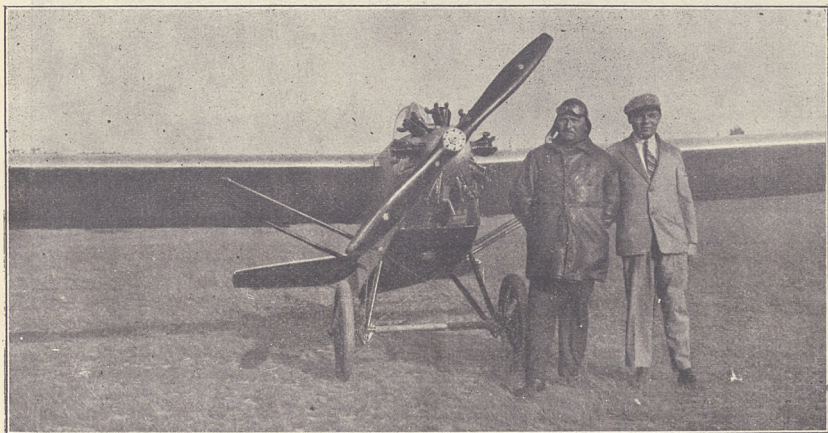
Awionetka jednomiejscowa, skonstruowana przez p. Bobka z silnikiem Salmson 40 KM.
