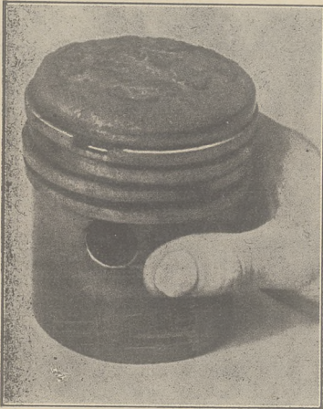
Ryc. 1. Kora koksowa, powstająca na nieszczelnym tłoku z powodu spalania się oleju, jest dużą przeskodą w jego chłodzeniu.
