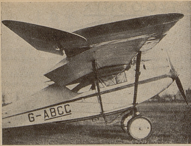
Włoski lotnik Ugo Antoni skonstruował nowy typ samolotu, mającego obok normalnych skrzydeł aparatu, dodatkowe małe skrzydła, kształtem i budową podobne do ptasich.
